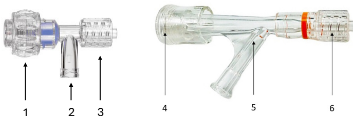
Abbildung 1 : Links: T-Flush mit Klemmschraube mit (1) mit dem die Dichtigkeit um die Sonde und die Reibung bei der Einführung eingestellt werden können (2) für die Spritze, sowie einem Klemmring und (3) der am Katheter befestigt wird, und dem Zugang.
