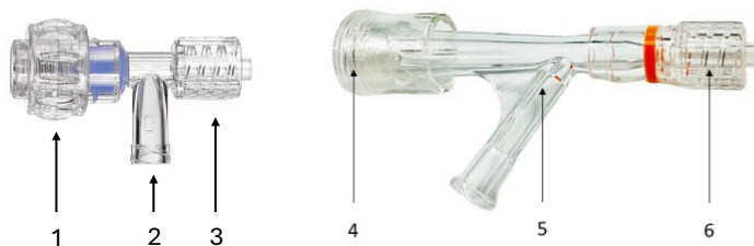
Figura 1: Esquerda: T-Flush por parafuso de aperto com (1) o anel de aperto que permite ajustar a estanquidade em torno da sonda e o atrito de inserção, (2) o acesso para a seringa e (3) a parte que se fixa no cateter.
