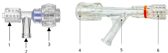
Figura 1 : Sinistra: T-Flush con vite di serraggio con (1) l'anello di serraggio che consente di regolare la tenuta intorno alla sonda, l'attrito di inserimento e (2) l'attacco per la siringa, e (3) la parte che si collega al catetere. Destra: T-flush con serraggio a pressione con (4) il meccanismo di serraggio che consente di regolare la tenuta intorno alla sonda, l'attrito di inserimento e (5) l'attacco per la siringa, e (6) la parte che si collega al catetere..
